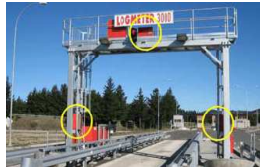
Figura 1. Logmeter 4000 de Woodtech. Los láseres están señalados con círculos amarillos.
