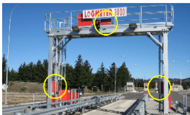
Imagem 1. Logmeter 4000 da Woodtech. O scanner laser está marcado com um círculo amarelo.
