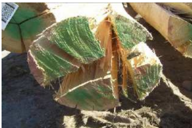
Imagem 9. Exemplo de rachaduras no extremo.
