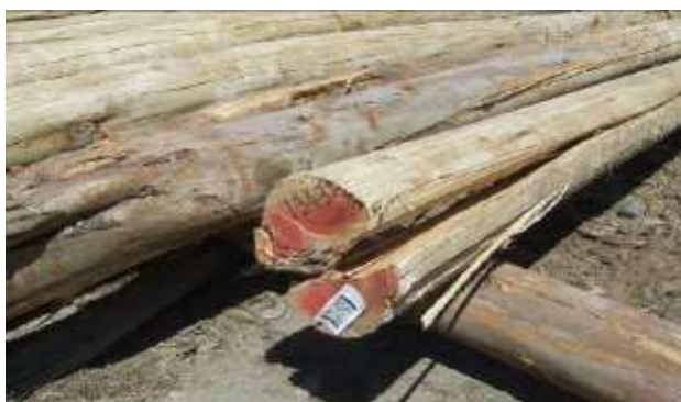
Imagem 10. Rachaduras na tora
